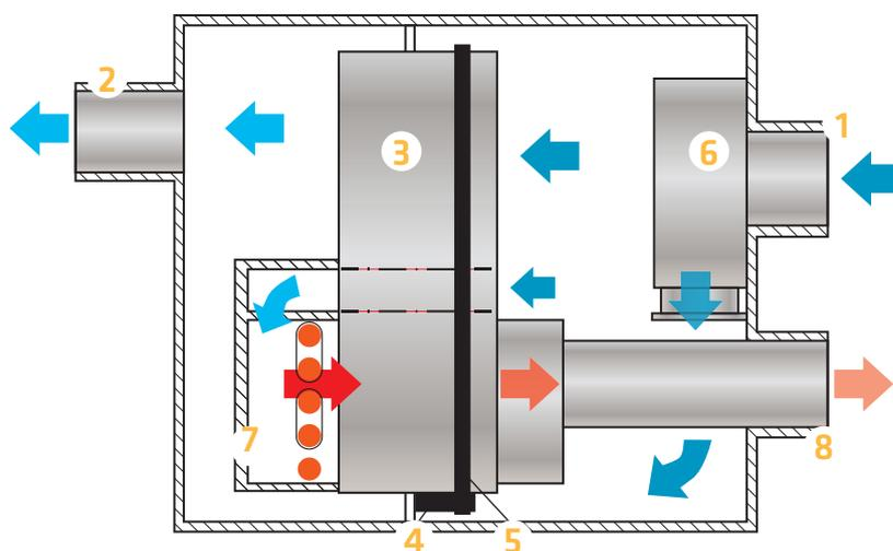
Schéma de principe du processus de déshumidification dans un déshumidificateur par adsorption rotatif.
