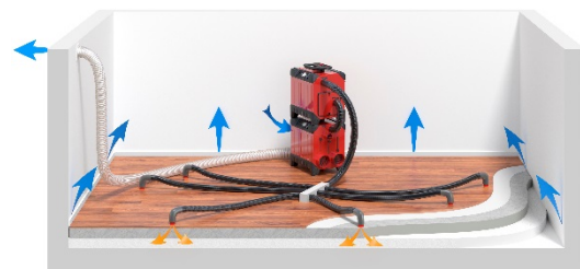
Assèchement par insufflation. La turbine est alimentée en air sec provenant du déshydrateur et le refoule dans la structure multicouches.
