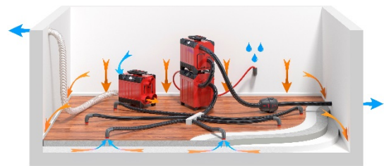
Assèchement par aspiration. Le déshydrateur assèche l'air dans la pièce et les turbines expulsent l'air de la structure multicouches, permettant ainsi à l'air sec d'être aspiré dans celle-ci.
