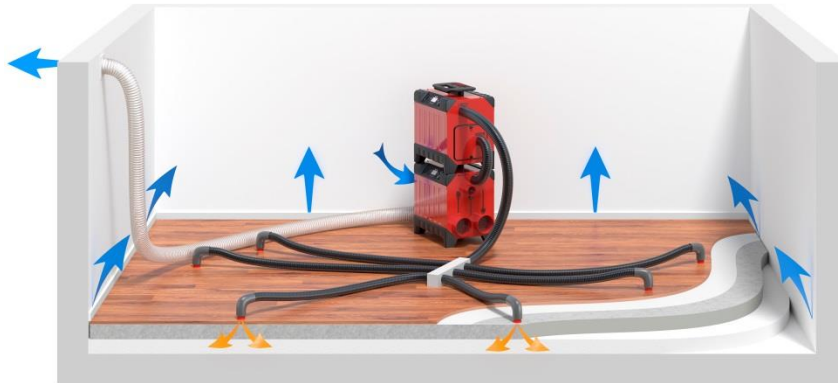
Assèchement par surpression. La turbine est alimentée en air sec par le déshydrateur et envoie cet air dans la construction multicouches.
