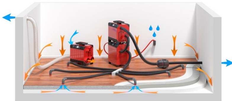
Assèchement par aspiration. Le déshydrateur assèche l'air ambiant et la turbine aspire et évacue l'air de la construction. La dépression générée dans la construction y aspire l'air sec.
