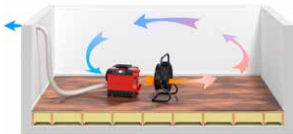
Wentylator wspomaga dystrybucję suchego powietrza w pomieszczeniu.
