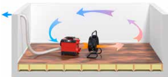
En avfukter blåser tø rr luft inn i hele rommet.
