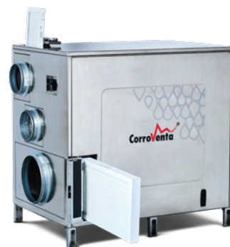
Filtr osuszacza można szybko i łatwo wymienić dzięki specjalnym okienkom. Nie trzeba odłączać kanałów ani demontować okienek serwisowych.
