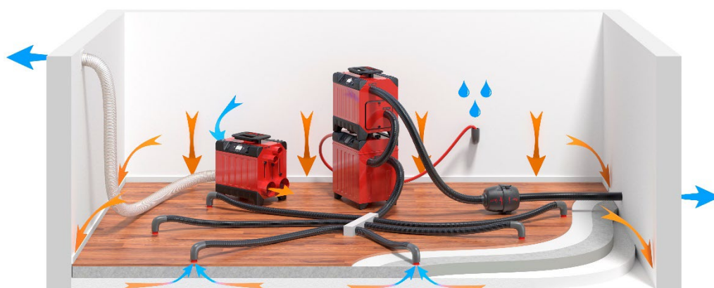
Osuszanie wyciągowe Osuszacz suszy powietrze w pomieszczeniu, a pompy wyciągają je z wewnątrz konstrukcji warstwowej przez co do środka może dostać się suche powietrze.
