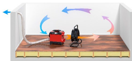
Mokre powietrze będzie zawsze odprowadzane przez wąż z osuszanego pomieszczenia. Na rysunku przedstawiono osuszanie pomieszczenia.
